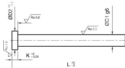
**ACCIAIO: PER PRESSOFUSIONE ED INIEZIONE**
