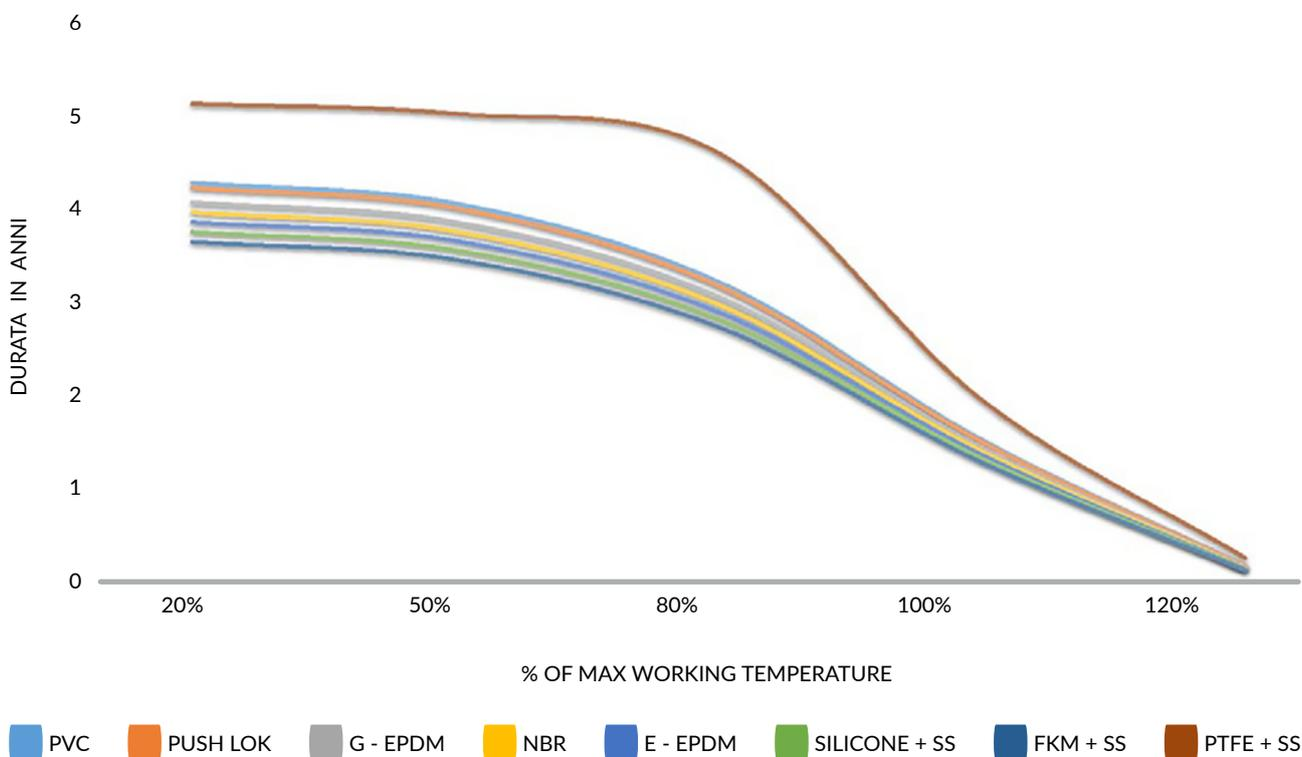
Le cifre sopra riportate sono solo dati teorici; le proprietà fisiche sono influenzate da diversi fattori come pressione, temperature ambiente, usura, additivi, luce solare, movimento, raggio di curvatura, fissaggio delle connessioni, ecc. Pertanto, il calcolo individuale della durata deve essere basato su tutte queste variabili.
