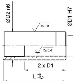
**MATERIALE:** ACCIAIO DA CEMENTAZIONE UNI 16CRNI4
